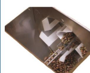
回転ドラムと水平振動レールで確実に搬送。ゴミなどによるレールの目詰まりを防止。
