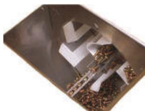
回転ドラムと水平振動レールで確実に搬送。ゴミなどによるレールの目詰まりを防止。
